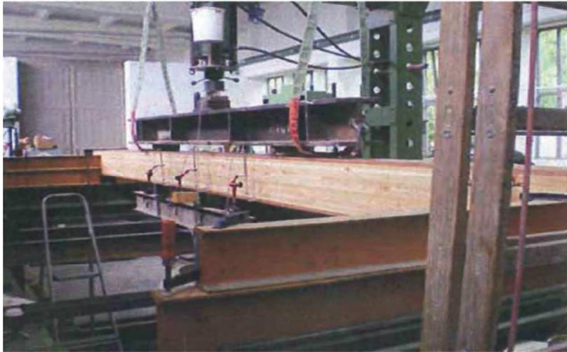
Abbildung 4: Belastungsversuch und Messeinrichtung an einem KHP-BSH-Hybridträger
