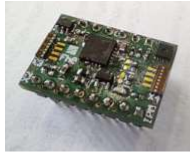
Bild 4: Sensorplatine aus kommerziellen Bausteinen, die die Funktionalität des kombinierten Sensors auch ohne integrierte CMOS-Schaltung ermöglicht.
