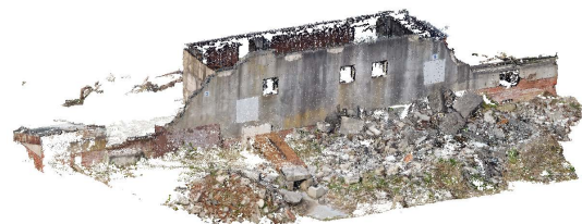
Bild 7 Photogrammetrische Punktwolke des Trümmerfeldes auf dem THW-Übungsgelände Wesel.
