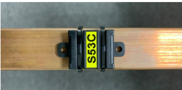
Bild 5 RFID-Sensor 25x25mm an einer Stromschiene befestigt
