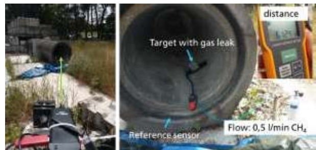
Bild 3 Ferndetektion eines künstlichen Gaslecks aus \sim 6 m Entfernung beim Feldtest.
