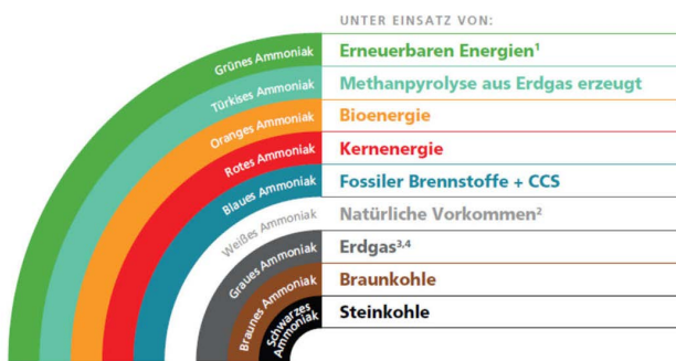
Bild 1 Bewertung der Klimaneutralität am Beispiel von Ammoniak aus Wasserelektrolyse und Stickstoff aus der Luft erzeugt, kommt nur in geringen Mengen auf der Erde vor, Dampfreformierung, derzeit das häufigste Erzeugungsverfahren.
