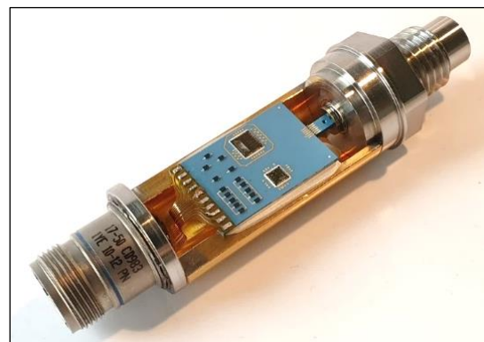
Bild 1 p,T Kombisensor mit integrierter Elektronik
