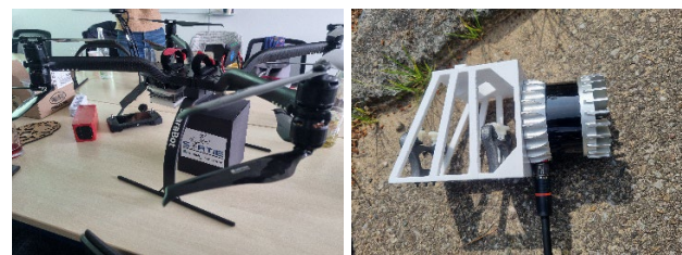
Bild 2 SORTIE-Drohne ohne Hardwareintegration (links) und LiDAR-Sensor (rechts).
