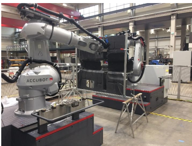
Bild 2 Vorläufiger Versuchsaufbau während der Prüfung eines CFK Fahrzeugunterbodens
