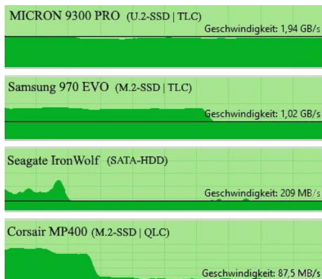
Bild 9 Kopiervorgang mit 140 GB großer Testdatei
