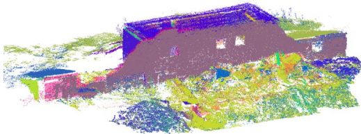
Bild 8 Segmentierung der Eingabepunktwolke mit dem RANSAC-Algorithmus von Open3D: Jede Farbe kennzeichnet ein eigenständiges Segment.
