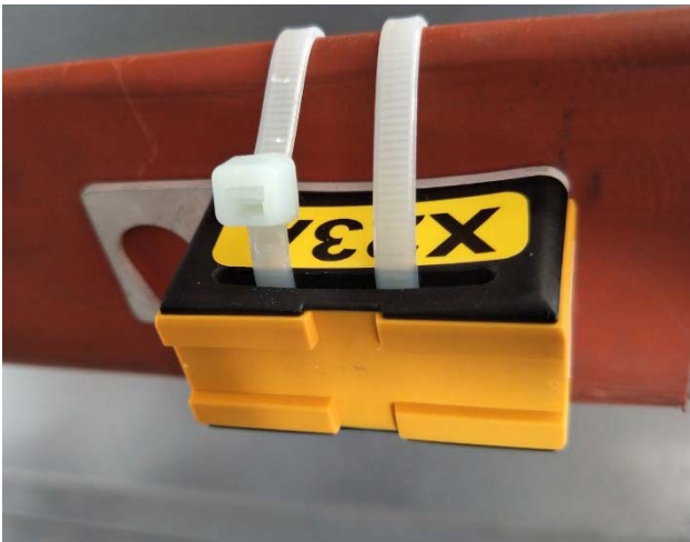
Bild 3 RFID-Sensoren an eine Stromschiene montiert
