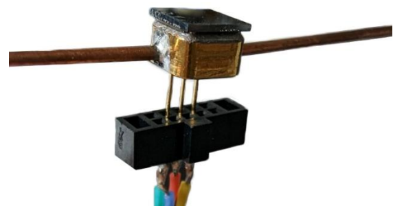
Abb. 5: Aufgebauter photoakustischer Detektor, hier mit Kupferröhrchen zur Befüllung mit dem Zielgas \text{CO}_2
