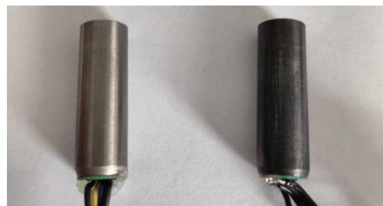
Abb. 3: Sensorstift mit Si-DMS (Fixierung: links geklebt, rechts Glasfritte).
