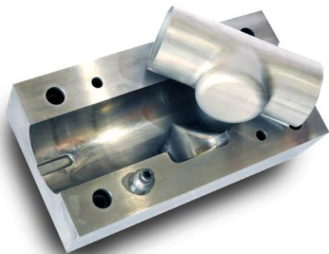
Abb. 1: Funktionsprinzip der IHU am Beispiel eines T-Stücks.
