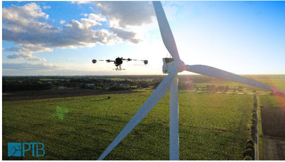
Abbildung 4: Messung des Lärms einer Windkraftanlage, hier gemessen aus der Luft auf Nabenhöhe.
