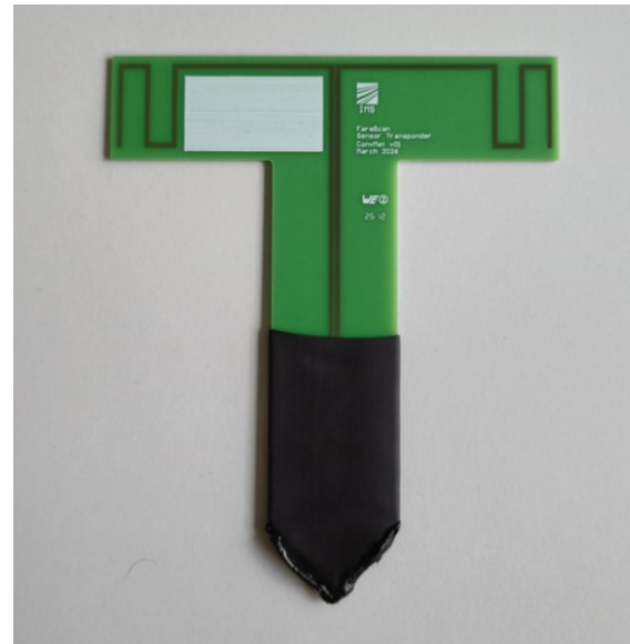
Abb. 6: Sensortransponder gefertigt aus konventionellen Materialien: Das Transponder-IC und der kapazitive Sensor befinden sich unter der schwarzen Schutzhülle.
