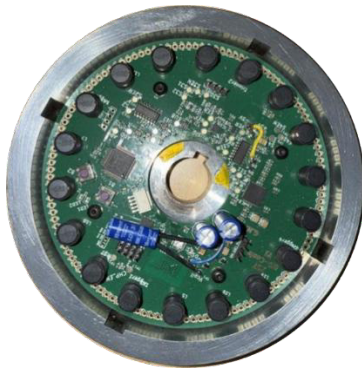
Abb. 5: Prototyp der Messelektronik montiert auf Scheibe 1 für die Versuche im Zweiseibentribometer
