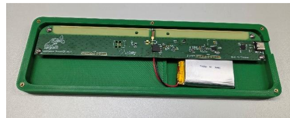
Abb. 9 Sensorelektronik mit Stromversorgung
