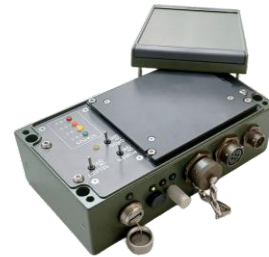
Abb. 4: Aufnahmebox für Schall, Kinematik, Umwelt- und Fahrzeugdaten
