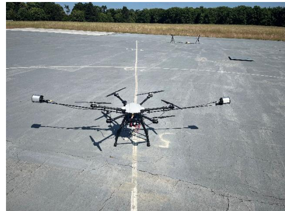
Abbildung 2: Versuchsaufbau einer Hexacopter-Drohne mit Mikrofonpaar.
