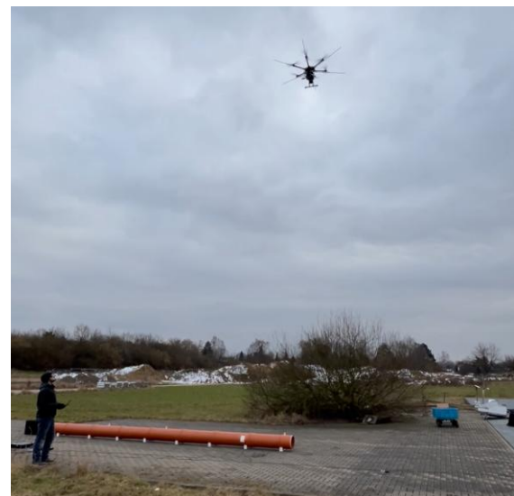
Abbildung 3: Messung der Schalleistung einer kalibrierten Schallquelle.
