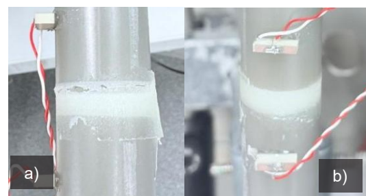
Abb. 8: Darstellung des Klebespaltes von zwei verschiedenen Hohlzylindern, a) Luft einschüsse im Klebespalt, b) ohne Luft einschüsse
