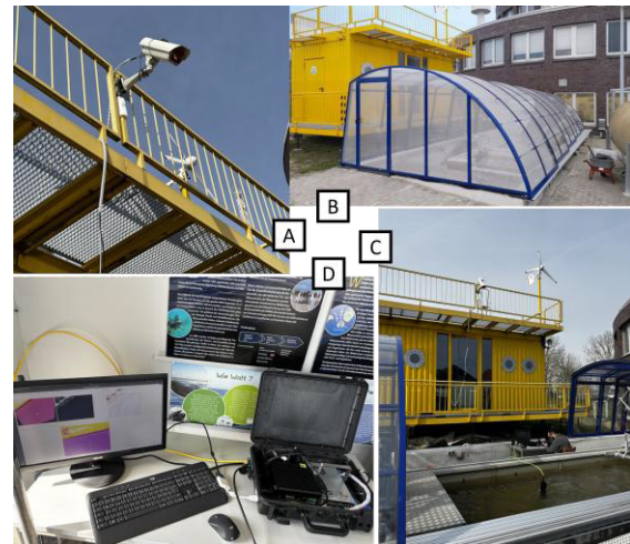
Abb. 3: Übersicht experimentelle Verifikation des entwickelten LSPIV-Systems. (A) kamerabasiertes Sensormodul oberhalb des überdachten Strömungsbeckens (B); (C) Übersicht des Messaufbaus mit ADCP in situ Referenzmessung; (D) dezentrale Verarbeitungseinheit innerhalb der Containeranlage.
