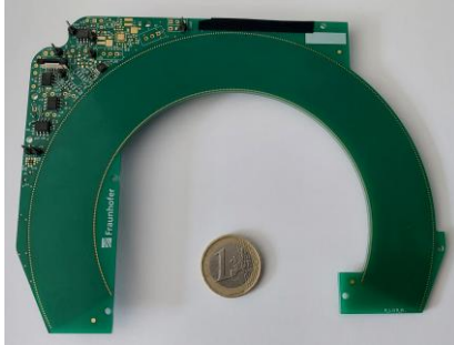
Abb. 4: Leiterplattenintegrierte Rogowskispule mit Öffnungswinkel ca. 117°, 2x174 Wicklungen und M \approx 68 \text{ nH} .
