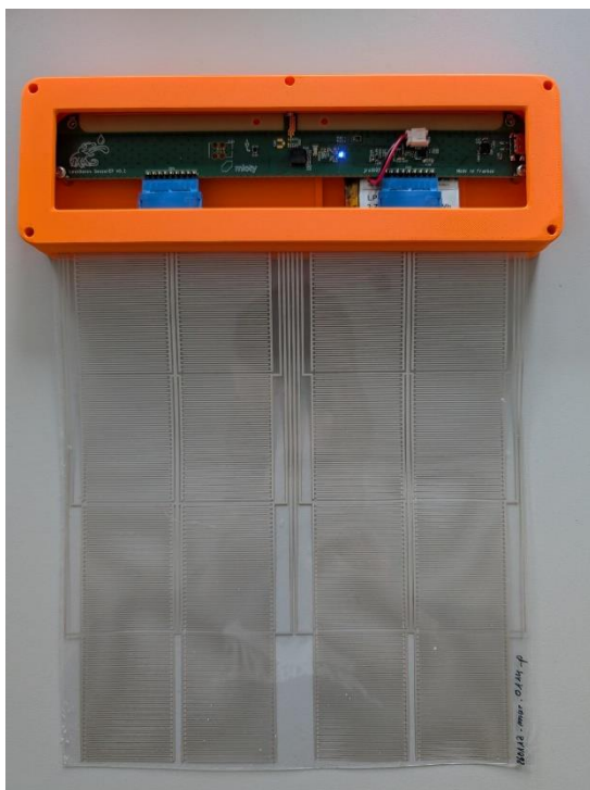
Abb. 10 Sensorarray mit angebundener Elektronik während Tests
