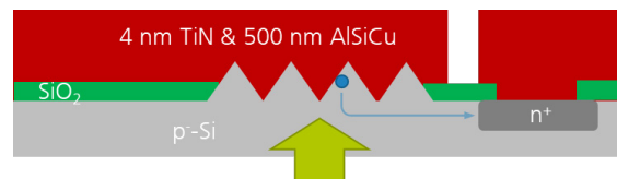
Abb. 1. Schematischer Querschnitt durch das Detektorbauelement.
