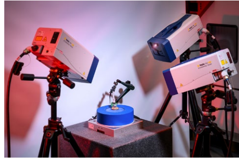
Abb. 4: Shaker und Laservibrometer im Labor des Fraunhofer IIS/EAS
