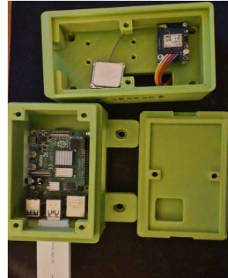
Abb. 2: Edge-Komponenten im Gehäuse [5]
