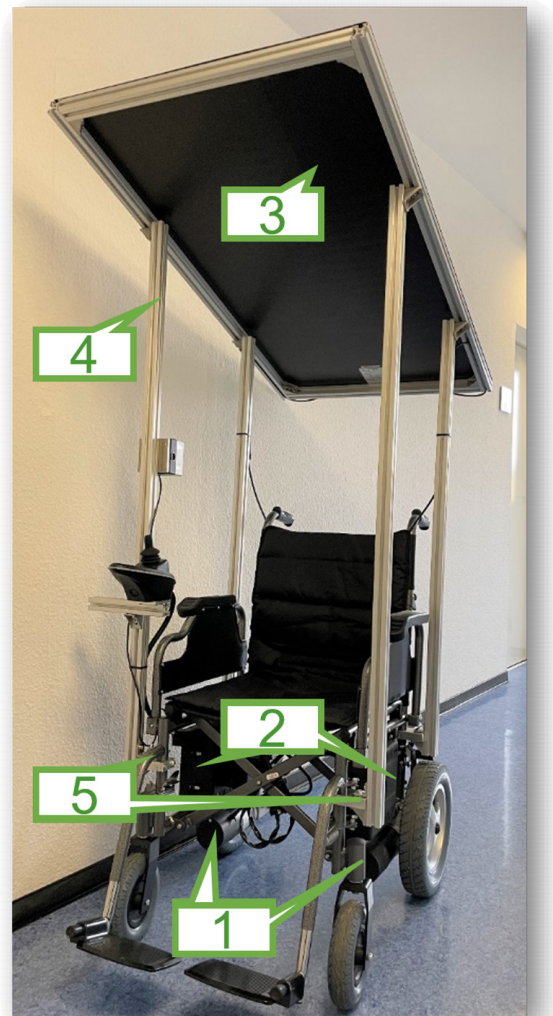
Abb. 2 Umgebauter Rollstuhl mit: 1. Elektromotoren, 2. LiFePo4-Batterien, 3. Solarpanel, 4. Aluminiumprofil und 5. Halterungssystem
