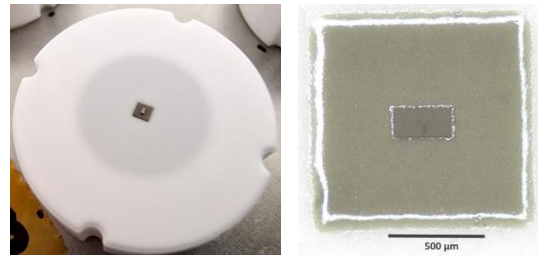
Abb. 1: Links: Makroaufnahme der monolithischen keramischen Druckmesszelle ( \varnothing 18 mm). Die Membran ist an dem dunklen kreisförmigen Bereich in der Mitte zu erkennen. Rechts: Mikroskopische Aufnahme der quadratischen Glasfrittschicht und der zentral angeordneten rechteckigen Diamantplatte der Größe (300 \times 150) \mu\text{m}^2 .
