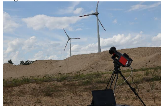
Abbildung 1: Der Messaufbau mit der IRT-Kamera, die aus einer Messentfernung von 190 m auf die WEA gerichtet ist.
