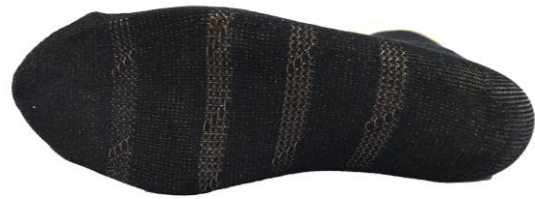
Abb. 5: Druckmessstrumpf der dritten Generation mit eingestricktem Buskabel
