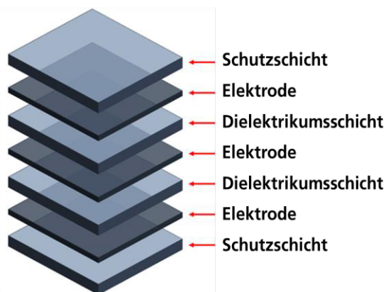
Abb. 2: Aufbau eines dielektrischen Elastomersensors
