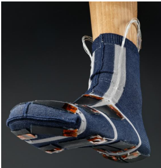
Abb. 4: Druckmessstrumpf der zweiten Generation mit 16 einzelnen Sensoren und Kabelschächten für die Signalkabel
