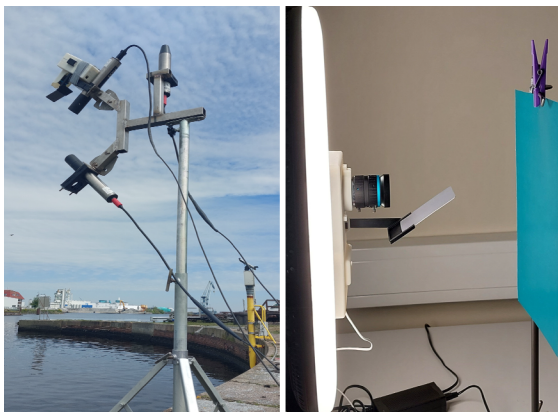
Abb. 8: Laboraufbau zur Ermittlung des Weißlichtabgleichs in Abhängigkeit der Umgebungslichttemperatur (rechts), Handhabungsstudie im Feldeinsatz des EOW-RPI Sensorsystems (links).
