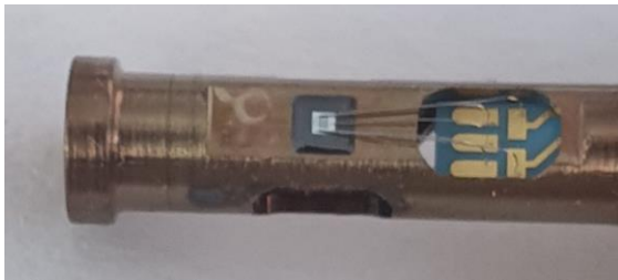
Abb. 11 Si-DMS gefügt mittels Glasfritte
