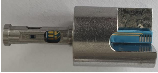
Abb. 10 Mechanischer Aufbau, Federkörper 1.4542, Si-DMS, Leiterplatte aus LTCC für den Anschluss des Si-DMS
