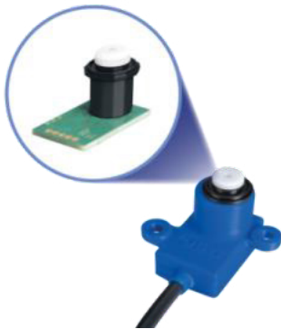
Abb.11: H 2 -Exhaust-Sensormodul, Testmuster, LxBxH ca. 36x23 / 43x28mm, Detail PCB LxB ca. 28x20mm mit H 2 -Gassensorkopf ca. Ø13mm [1]
