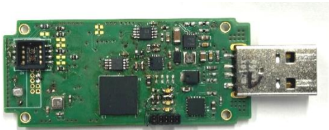
Abb. 4: Funktionsdemonstrator des funktional sicheren Sensorsystem für die Wasserstoff-Detektion. Links auf der Platine befindet sich ein keramischer Wärmeleitfähigkeitssensor, zwei MEMS-Pellistoren und ein kommerzieller Feuchte- und Temperatursensor (Bosch BME 680). Zur Signalverarbeitung dient ein PSOC \mu C (Infineon) mit einem ext. 16bit DAC/ADC. Der Datenaustausch mit einem PC und die Stromversorgung wird durch ein USB-Interface gewährleistet.
