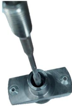
Abb. 3: Messprobe mit Ankerelement.
