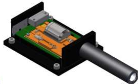
Bild 4 Renderbild der mechanischen Zeichnung des Quanteninterferenzmoduls.
