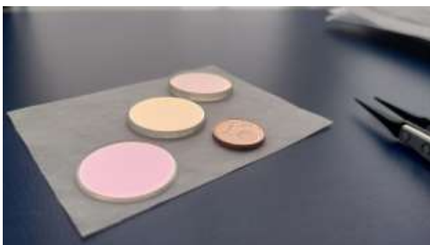
Bild 8 Foto von drei \text{CaF}_2 Proben mit d = 1 mm, 2 mm und 3 mm. Die Proben sind hochreflektierend im sichtbaren und nahinfraroten Bereich.
