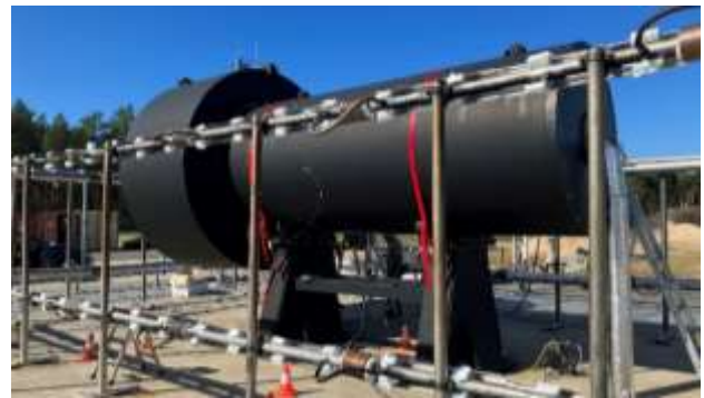
Abbildung 2 Feuerreferenzbehälter in einem Brandprüfstand mit zwei Brennerringen, vgl. [8].
