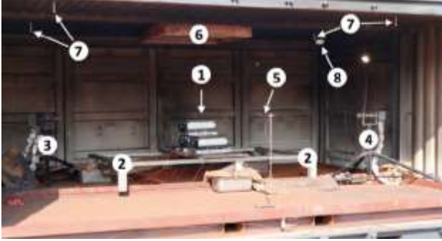
Abbildung 4 Batterieprüfstand für Module und reale Batterien mit 1) Module ausgestattet mit Thermoelementen, 2) Versuchstisch, 3) - 4) Diodenlaser-Spektrometer für HF-Konzentration (Flusssäure), 5) Nahfeld-Thermoelemente, 6) Abzugshaube, 7) Hochdruck-Wasserebelanlage und 8) Kamerasystem, vgl. [9, 16].
