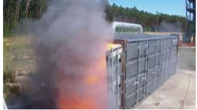
Abbildung 6 Gasexplosion infolge des Ausgasens verursacht durch thermisches Durchgehen eines 2,65kWh-Moduls [14].
