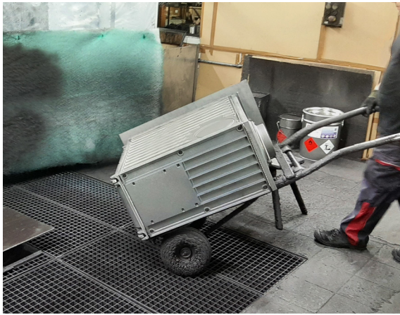
Fig. 3: Ofeneinsatz mit innen befestigtem BLE-Tag
