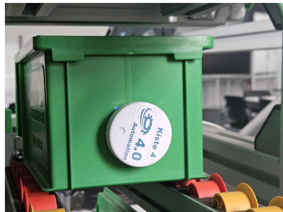
Fig. 2: Ein BLE-Tag an einer Materialkiste befestigt
