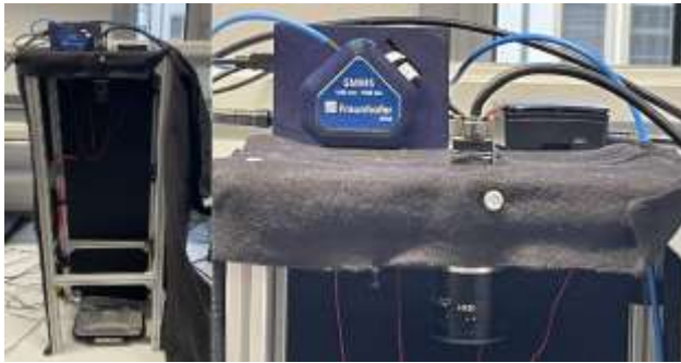
Bild 2 Demosystem der intelligenten Hyperspektralkamera(links), Spektrometer & Kamerasystem (rechts)
