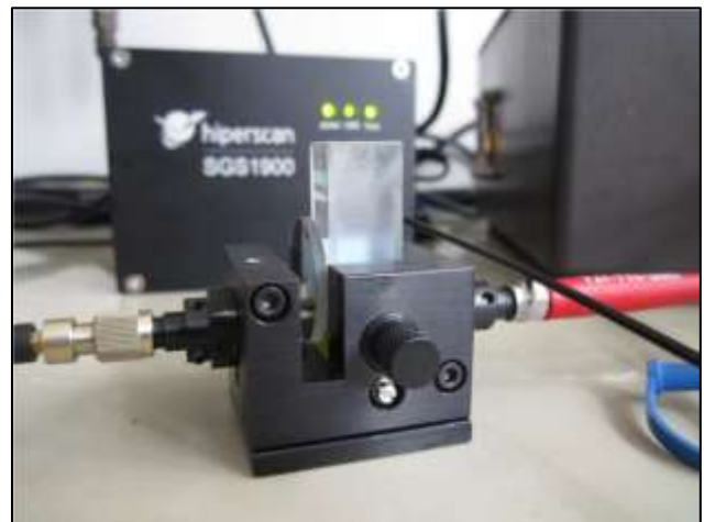
Bild 6 Messung an flüssigen Proben wie Milch, Olivenöl oder wässrigen Zuckerlösungen
