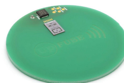
Bild 2 realisiertes RFID-Sensortag mit Stoßsensor
