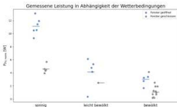
Bild 5 Leistung in Abhängigkeit der Wetterbedingungen für zwei Solarmodule im Innenbereich
