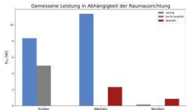
Bild 2 Gemessene Leistung der Solarmodule im Innenraum in Abhängigkeit von der Ausrichtung
