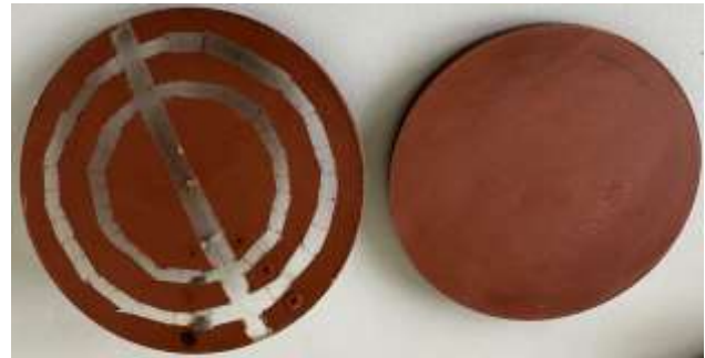
Bild 3 mit segmentierten Kondensatorflächen beschichtetes Scheibe-Scheibe-System
