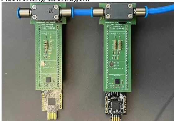
Abb. 2: PSoC 5-Entwicklungsboard mit aufgesetzter Sensorplatine. Links befindet sich das Einzelmikrofonsystem, rechts das Doppelmikrofonsystem. Ein 3D-gedruckter Gehäusekopf mit Gasanschlüssen dient zur Integration der Sensoren in den Messplatz. Die Dual-Backplate-Mikrofone sind auf der Sensorplatine montiert.
