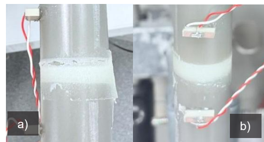
Abb. 8: Darstellung des Klebspaltes von zwei verschiedenen Hohlzylindern, a) Luft einschüsse im Klebspalt, b) ohne Luft einschüsse
