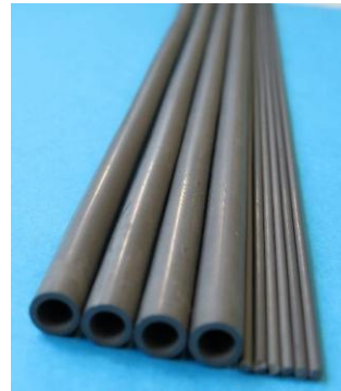
Abb. 2: Vorgesinterte extrudierter Rohre und Stäbe aus B_4C/TaB_2 -Kompositwerkstoffen.
