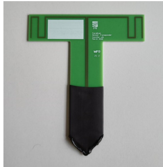
Abb. 6: Sensortransponder gefertigt aus konventionellen Materialien: Das Transponder-IC und der kapazitive Sensor befinden sich unter der schwarzen Schutzhülle.
