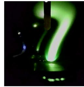
Plasmainstabilität kurz vor Plasmaabriss -&gt; Starkes Flattern an Elektrode
