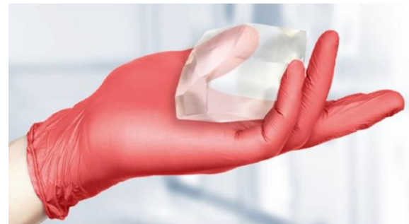
Abb. 5: Foto eines DLaTGS-Kristalls nach der Entnahme aus der Züchtungslösung.
