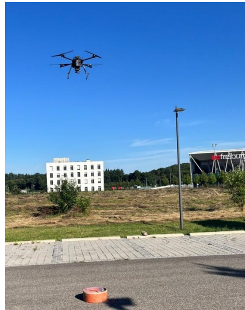
Abb. 5: Überflug der Drohne über ein simuliertes Gasleck. Der Gassack ist mit 1 Vol.-% Methan gefüllt und mit einem KG-Rohr am Boden fixiert.
