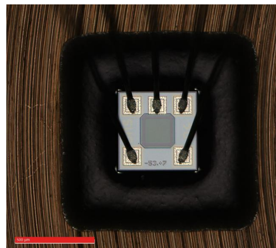
Abb. 7: Drahtgebondeter Si-DMS, gefügt mit Glasfritte auf Stahlrunde (1.4542), Prozesstemperatur ca. 420 °C [2]
