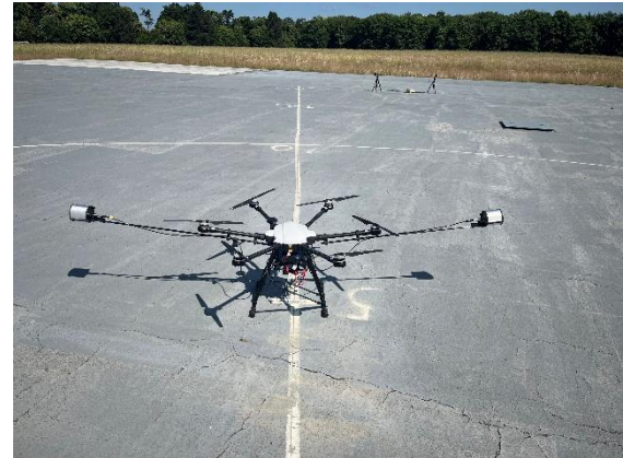
Abbildung 2: Versuchsaufbau einer Hexacopter-Drohne mit Mikrofonpaar.
