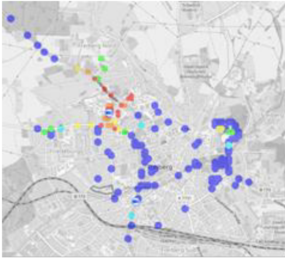
Abb. 2: Karte (Heatmap) mit Gateways in Freiberg und Umgebung sowie der der Empfangsstärke
