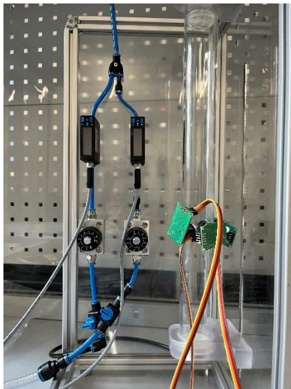
Abb. 2: Versuchsaufbau zur Messung der Ansprechzeit mit Gasreglerung auf der linken Seite und senkrechten Strömungsrohr mit Sensoren rechts.
