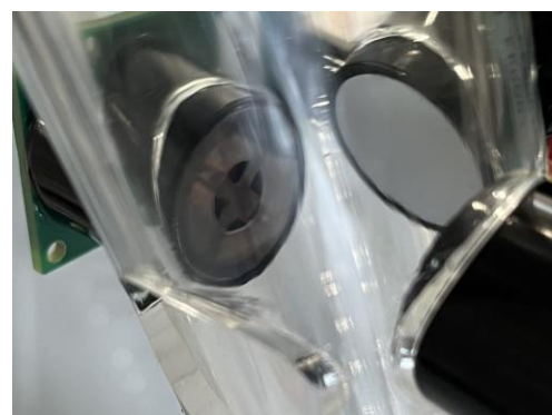
Abb. 4: Referenzsensor ohne Membran und Sensor mit Schutzmembran im Strömungsrohr angeordnet.
