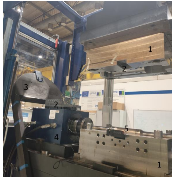
Abb. 5: IHU-Anlage mit integriertem Versuchsaufbau (1 Umformwerkzeug mit Unter- und Obergesenk, 2 Messtechnik, 3 Zugbügel, 4 Hydraulik, 5 T-Stück).
